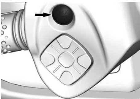
TYPIQUE - BOUTON START/STOP DU MOTEUR
