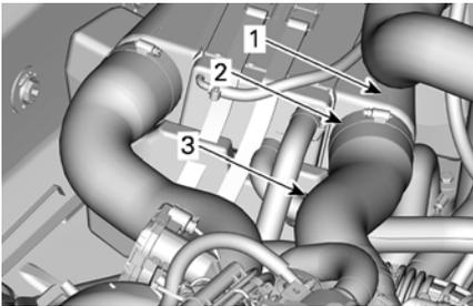
1. Ausrichtungslinien am Schlauch
