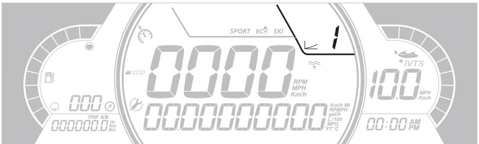
Diese Anzeige zeigt die Getriebestellung des iBR an:
