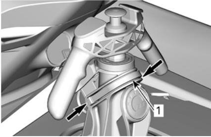
**TYPISCH - ZUM ENTRIEGELN NACH VORN SCHIEBEN UND DEN ZUGMAST HERAUSZIEHEN**
