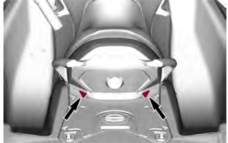
2. Ziehen Sie dann den Verriegelungshebel nach oben und entfernen Sie den vorderen Sitz vom Wasserfahrzeug.
