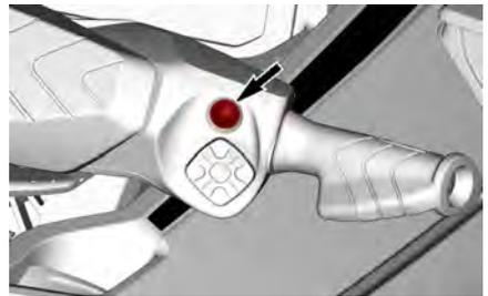
Dieser Schalter ermöglicht schnellen Zugriff auf BRP Connect. Mit jeder Betätigung wird zwischen der App-Ansicht und der Funktionsansicht der Multifunktionsanzeige umgeschaltet.
