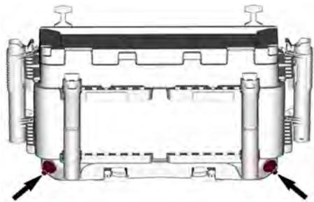
Installez les tubes à l'intérieur de la glacière en les vissant dans les nouveaux raccords filetés.
