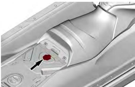
Insérez le poteau dans le trou de montage. Stabilisez-le avec la sangle. Le poteau peut être installé vers l'avant ou l'arrière. Un bip sonore confirme l'installation du poteau. Un message s'affiche sur l'écran numérique en cas de dysfonctionnement du système. Dans ce cas, consultez votre revendeur ou votre distributeur.
