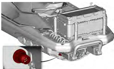
L'eau douce peut être fournie 30 secondes toutes les trois minutes ou en continu, contrôlée par l'interrupteur. La fonction intermittente est conçue pour minimiser le drainage de la batterie lorsque le moteur est arrêté.
