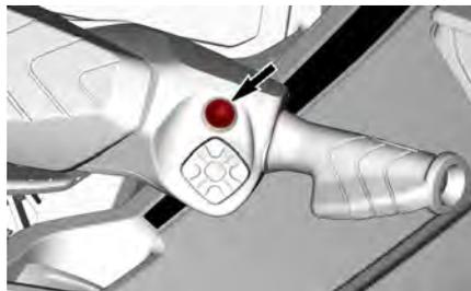
Ce bouton offre un accès rapide à BRP Connect. Chaque clic permutera entre la vue des applications et la vue des fonctions de l'indicateur multifonction.
