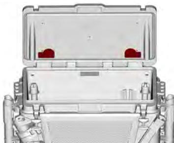
Retirez les deux bouchons de vidange et installez les raccords filetés du vivier.
