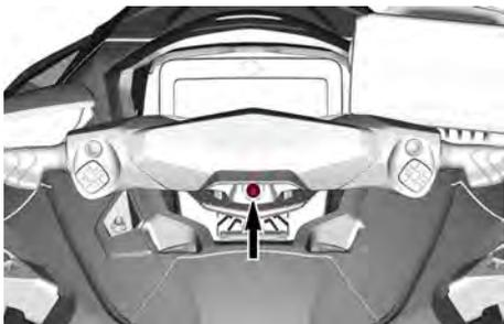
Pour que le moteur démarre, le capuchon du cordon d'attache doit être solidement fixé à l'interrupteur coupe-circuit du moteur.
