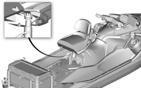
Pour installer correctement le dossier, vérifiez qu'il est complètement inséré. Une distance de 10 mm (3/8 in) est normale.
