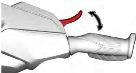
La palanca del acelerador está accionada por resorte y debería recuperar la posición de ralentí al dejar de presionarla.
