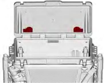
Quite los dos tapones de drenaje e instale las conexiones roscadas del depósito de cebo.
