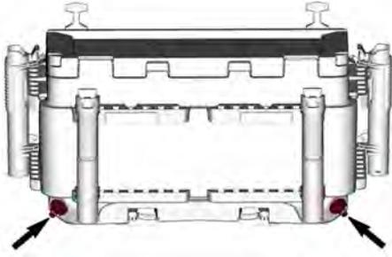
Instale los tubos dentro del refrigerador atornillándolos en las nuevas conexiones roscadas.
