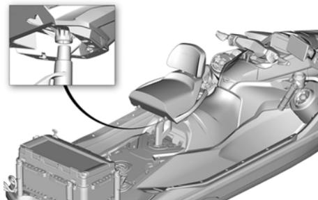
Para instalar el respaldo de forma adecuada, asegúrese de que se haya insertado completamente. Una distancia de 10 mm (3/8 pulg.) es normal.
