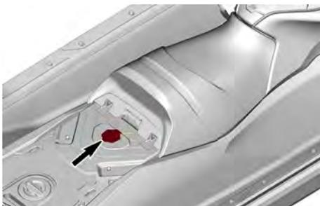
Inserte el poste en el orificio de montaje. Sujételo con la correa. Se puede instalar el poste en la parte frontal o posterior. Se escuchará un pitido para confirmar la instalación del poste. Aparecerá un mensaje en la pantalla digital si hay alguna falla del sistema. En ese caso, consulte a su concesionario o distribuidor.
