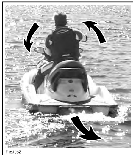
典型示例 - 后退时转向方向相反
