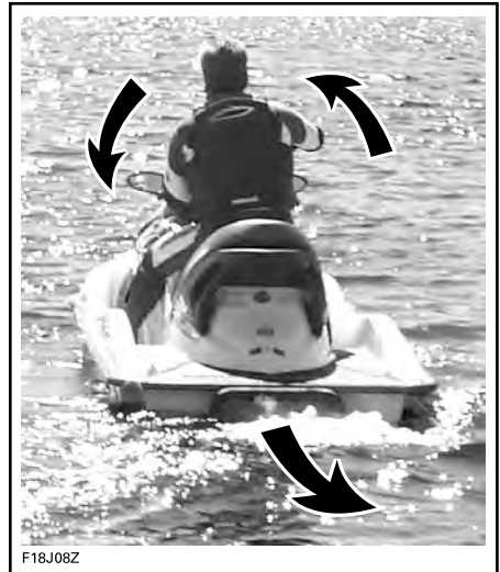
TYPEBILDE – STYRERETNINGEN ER MOTSATT NÅR DU RYGGER
