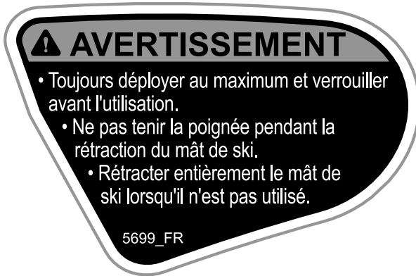
MÂT DE SKI RÉTRACTABLE - UTILISATION - ÉTIQUETTE D'AVERTISSEMENT
