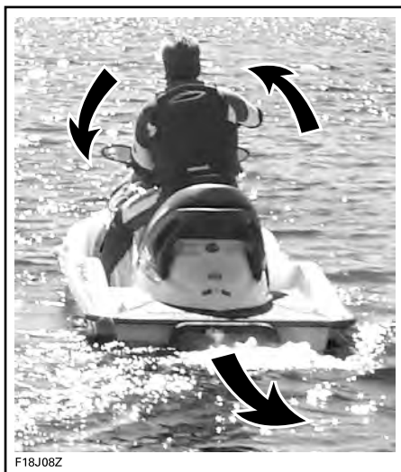
典型示例 - 后退时转向方向相反
