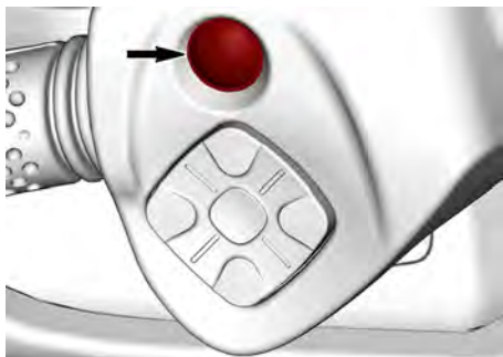
TÍPICO - BOTÓN DE ARRANQUE/PARADA DEL MOTOR
