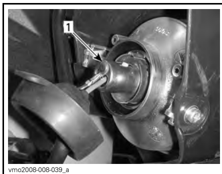
TRYKK PÅ OG DREI PÆREHOLDEREN MOT KLOKKEN 1. Pæreholder
