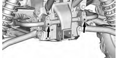
TÍPICO - BARRA ESTABILIZADORA TRASERA
