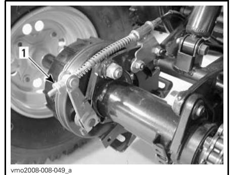
1. Brake cable adjuster
