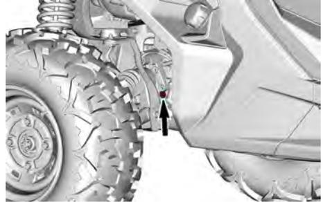
3. Entfernen Sie den Einfüllstopfen.
