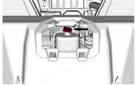
2. Geben Sie nach Bedarf Kühlmittel in das System. Mit einem Trichter vermeiden Sie das Verschütten von Flüssigkeit. **Nicht überfüllen.**
