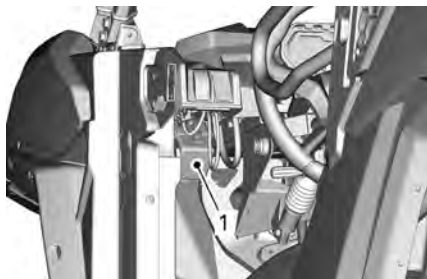
1. Boîte à fusibles avant
