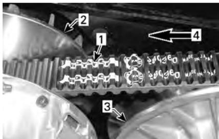
1. Flèche imprimée sur la courroie
