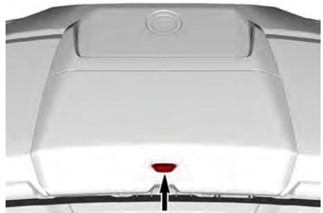
2. Pour fermer le couvercle de service avant, poussez-le vers le bas jusqu'à l'enclenchement.
