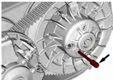
4. Tournez la poulie entraînée jusqu'à ce que la partie la plus basse des pignons sur la surface externe de la courroie d'entraînement soit alignée sur le bord de la poulie entraînée.
