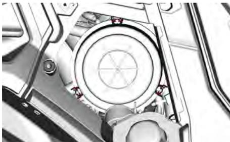
3. Le filtre est très serré sur le tube de sortie et offre une résistance initiale.
