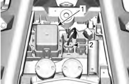
1. Vorderer Sicherungskasten 2. DPS-Sicherung
