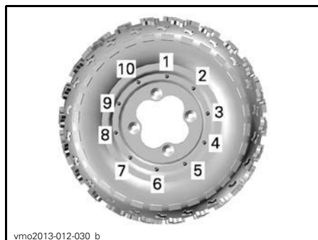
ROUE À VERROU DE TALON À 10 BOULONS — SÉQUENCE DE SERRAGE DE LA DERNIÈRE ÉTAPE
