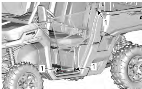
1. Emplacements de réglage des filets latéraux
