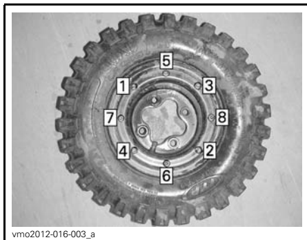
ROUES À VERROU DE TALON À 8 BOULONS — SÉQUENCE DE SERRAGE DE LA PREMIÈRE ET DE LA DEUXIÈME ÉTAPE
