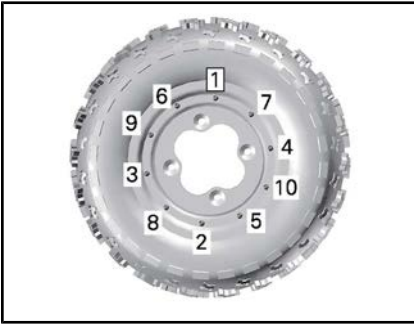
LLANTAS CON SISTEMA DE BLOQUEO DE TALÓN DE DIEZ PERNOS: PRIMER Y SEGUNDO PASO DE LA SECUENCIA DEL PAR DE APRIETE
