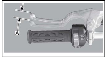
PALANCA DEL EMBRAGUE — AJUSTE CORRECTO
