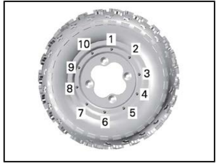
LLANTAS CON SISTEMA DE BLOQUEO DE TALÓN DE DIEZ PERNOS: ÚLTIMO PASO DE LA SECUENCIA DEL PAR DE APRIETE
