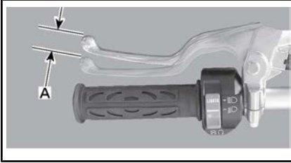
PALANCA DEL EMBRAGUE — HOLGURA NOMINAL
