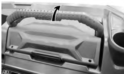
FIXAÇÃO DA CAIXA DE FERRAMENTAS NO LUGAR
