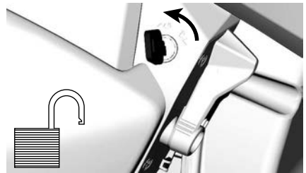
1. PARK-Hebel in der gelösten Position (nicht eingestellt)
