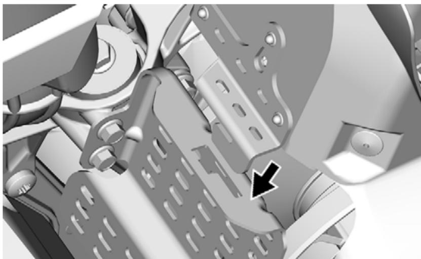
Poussez le protège-courroie de distribution vers l'avant du moteur pour vers l'avant du véhicule.
