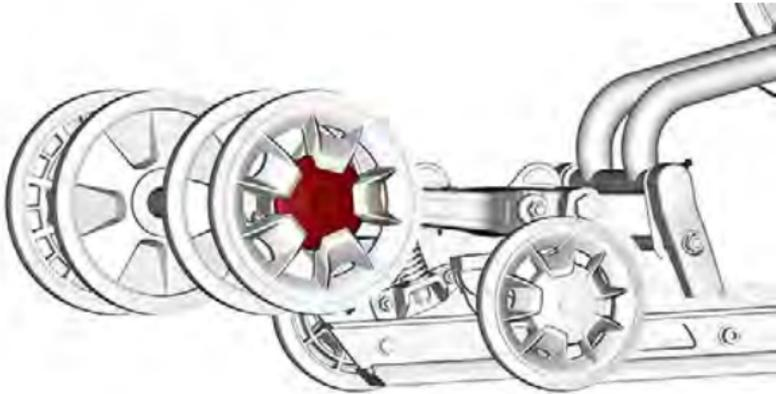
5. Lösen Sie die Halteschrauben der hinteren Zwischenräder.
