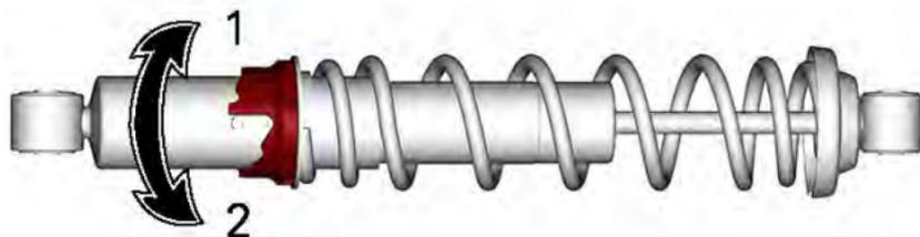
1. Vorspannung erhöhen
