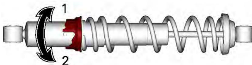
1. Vorspannung erhöhen
