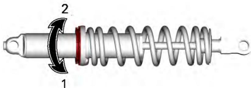
1. Vorspannung erhöhen
