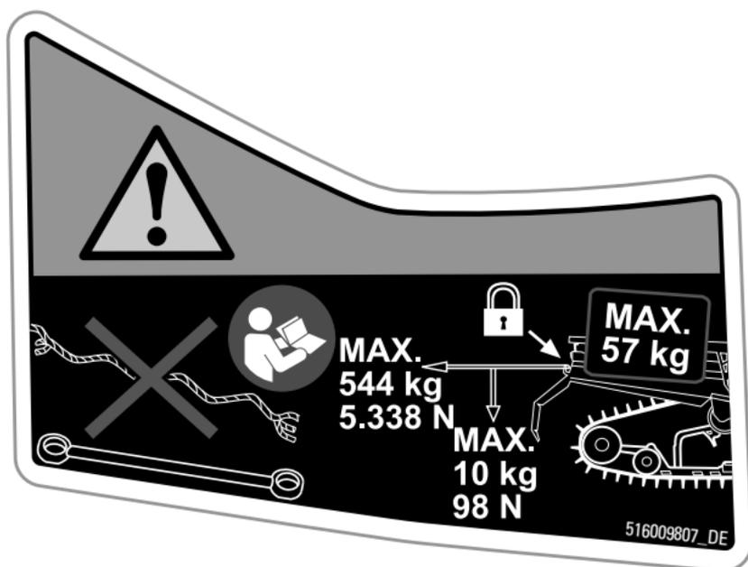
MAXIMALE ZULADUNG UND ZUGLAST – WARNSCHILD
