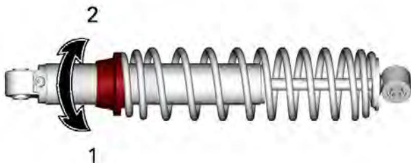
1. Vorspannung erhöhen
