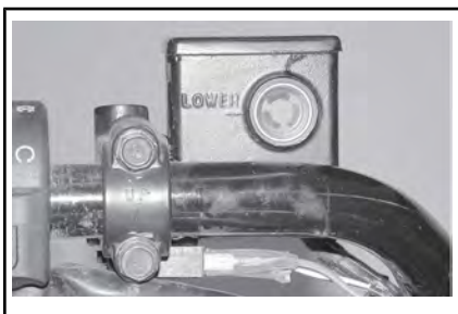
TÍPICA — RESERVATÓRIO ESQUERDO, DO FLUIDO DO FREIO TRASEIRO
