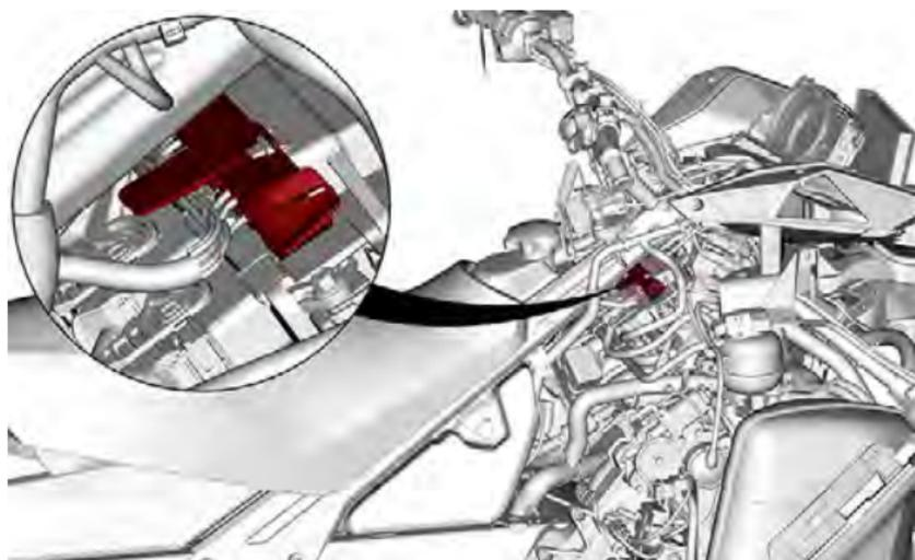
**CONFIGURAZIONE TIPICA - BLOCCO RELÈ (SE IN DOTAZIONE)**
