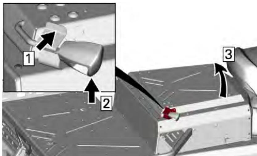
Fare in modo che la maniglia della copertura sia chiusa correttamente quando si chiude la copertura.
