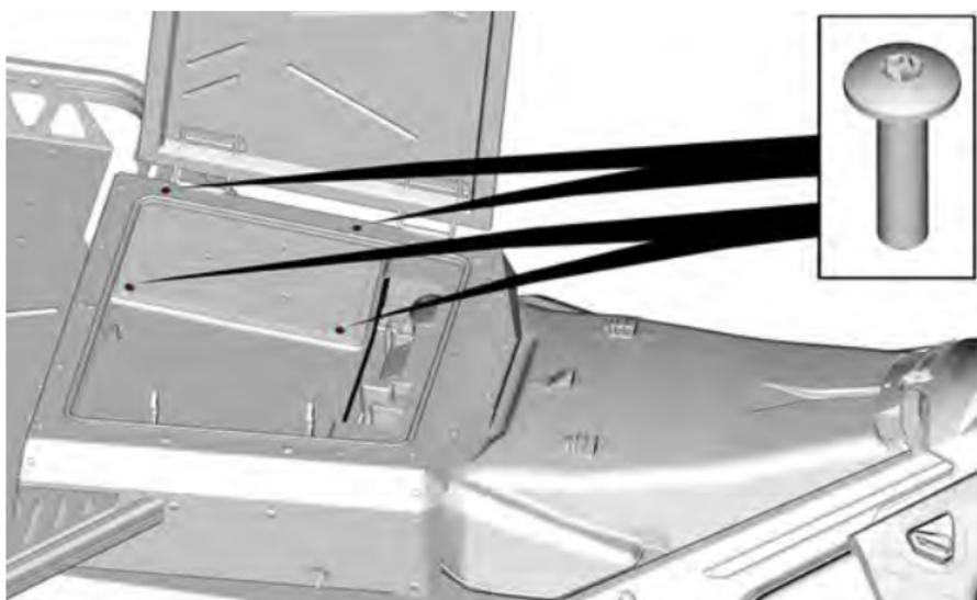
5. Ruotare il pannello per accedere ai connettori posti nella parte posteriore.
