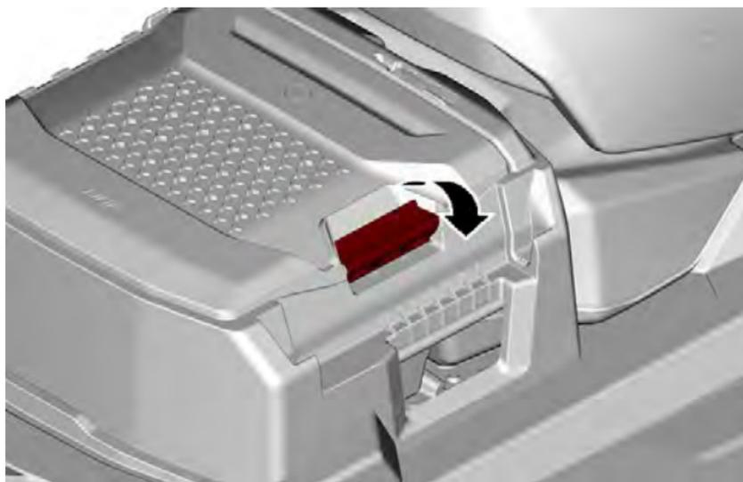
Fare in modo che la maniglia della copertura sia chiusa correttamente quando si chiude la copertura.
