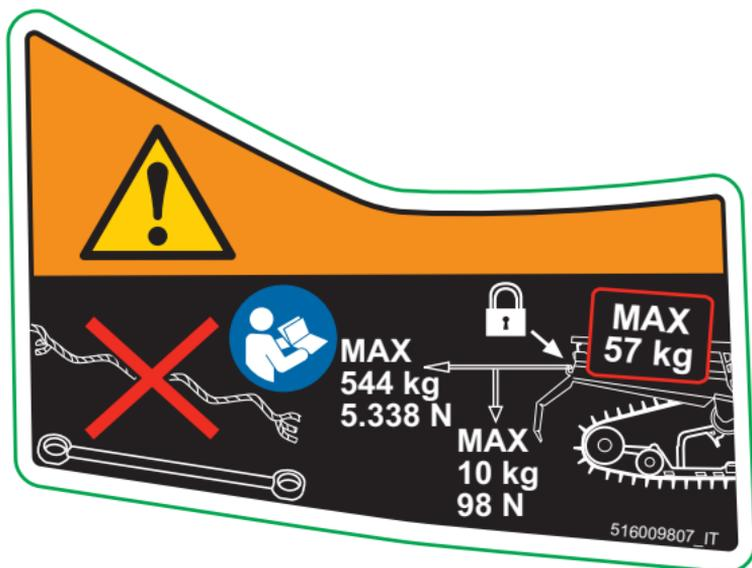
**CAPACITÀ DI CARICO E TRAINO MASSIMA DI RANGER PRO - ETICHETTA DI AVVERTENZA**
