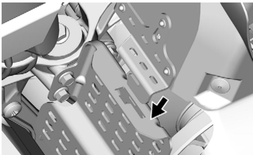
Spingere la protezione della cinghia di trasmissione verso il motore e poi verso il davanti del veicolo.
