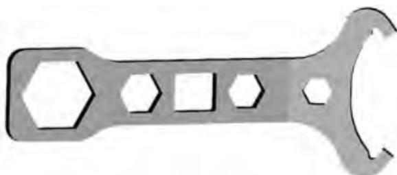
**STRUMENTO DI REGOLAZIONE DELLE SOSPENSIONI**
