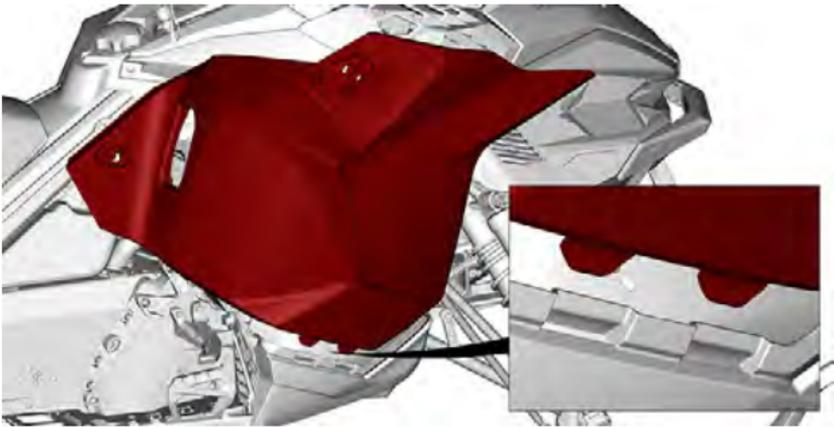
**Installazione dei pannelli laterali - Con sistema con iniezione d'acqua**
