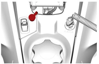
TYPICAL — DRIVER - ELECTRIC VISOR JACK CONNECTOR LOCATION
