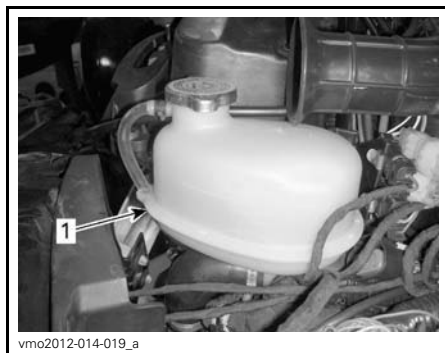
1. Réservoir de liquide de refroidissement
