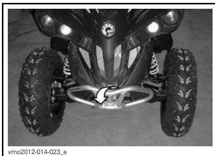
TYPIQUE - EMPLACEMENT DU POINT D'ARRIMAGE AVANT
