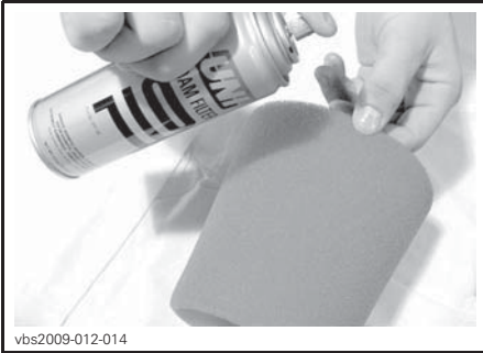
TYPISCH - FILTER MET OLIE SMEREN
