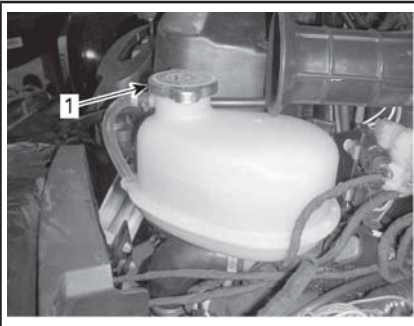
1. Tappo serbatoio liquido refrigerante del motore
