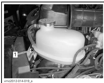
1. Réservoir de liquide de refroidissement
