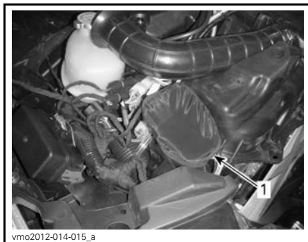
1. Filtre à air de la transmission CVC
