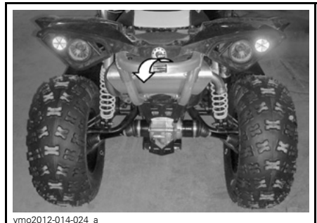
TYYPILLINEN - KIINNITYSKOHTA TAKANA
