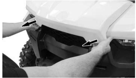
AN DEN VORDEREN KANTEN DER WARTUNGSABDECKUNG ZIEHEN.
