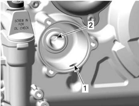
1. Einlass-Bohrung der Ölpumpe zum Ölfilter
