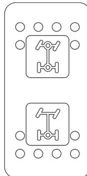
Mit diesem Schalter wird bei stehendem Fahrzeug der Vierrad- oder Sechsradantriebsmodus ausgewählt.
