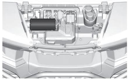
Zum Ausbauen Filter anheben und verschieben.
