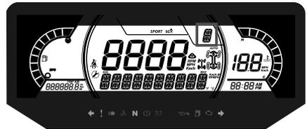
Diese Anzeige zeigt die Getriebestellung an:
