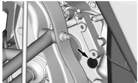
4. Entfernen Sie den Einfüllstopfen.
