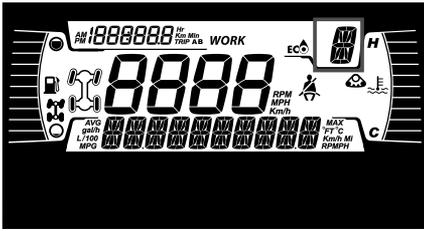
Diese Anzeige zeigt die Getriebestellung an:
