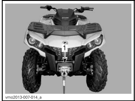
1. Placering av främre fästpunkt
