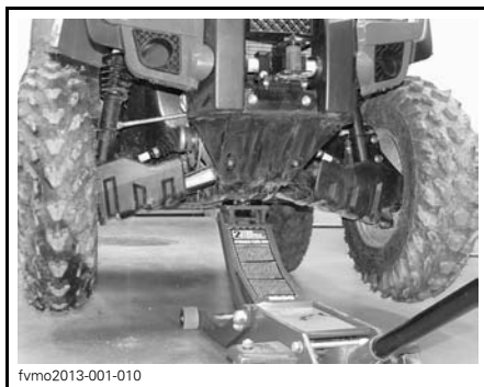
TYPBILD — PLACERING AV FRÄMRE LYFTPUNKT
