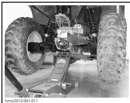
TYPBILD — PLACERING AV BAKRE LYFTPUNKT
