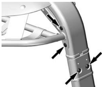
PARAFUSOS DA FRENTE DA ESTRUTURA DO TOLDO – LADO ESQUERDO
