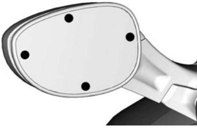
PUNTI DI REGOLAZIONE DEGLI SPECCHIETTI - MODELLI STD E S
