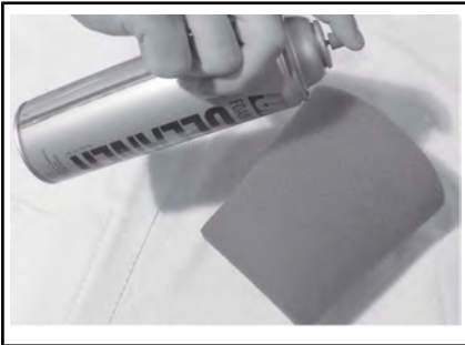
TÍPICA - BORRIFE O ELEMENTO DE ESPUMA
