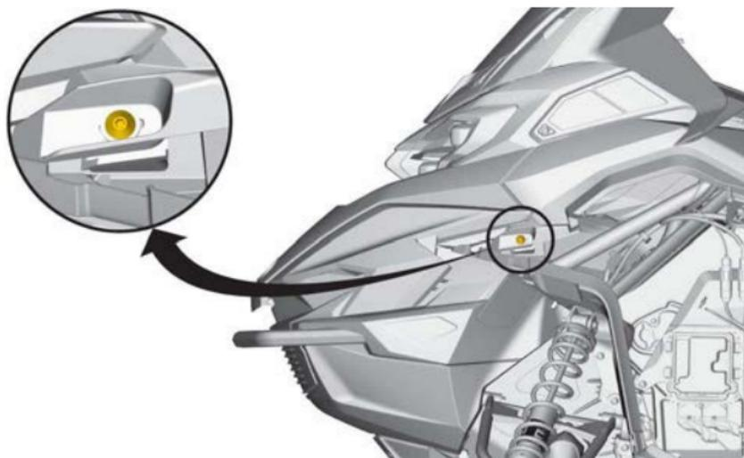
5. Saisissez le module de carrosserie supérieur dans la section du support d'instrumentation.
