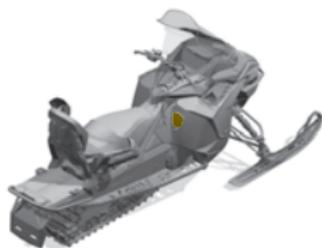
Le port de charge est situé dans le coin inférieur droit de la vue du conducteur. Il est configuré pour accepter le chargement de type 2 (Mennekes) (240 V).
