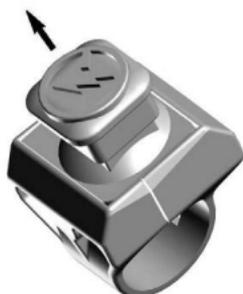
3. Appuyez sur le bouton Démarrer de l'interrupteur multifonction du guidon pendant 0,5 seconde. L'indicateur ON s'affiche en bas à gauche de l'écran.
