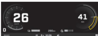
La puissance du freinage régénératif obtenue peut être surveillée dans cette zone de l'indicateur de puissance.
