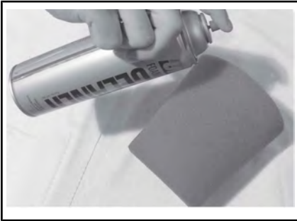
TYPISCH - SCHAUMSTOFFFILTERELEMENT BESPRÜHEN
