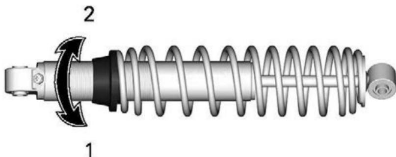
1. *Vorspannung erhöhen*
