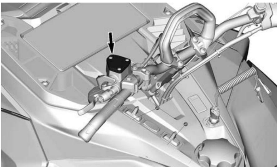
2. Entfernen Sie die Halteschrauben des Behälterdeckels.
