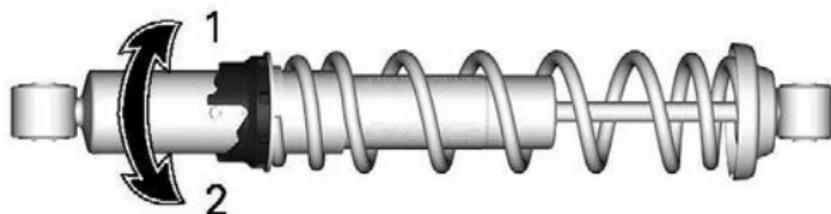
1. *Vorspannung erhöhen*
