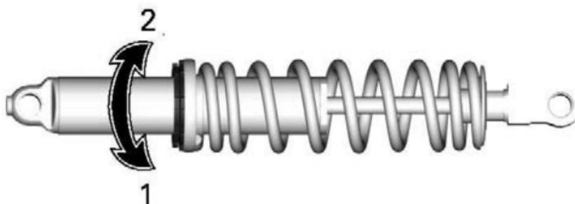
1. Vorspannung erhöhen
