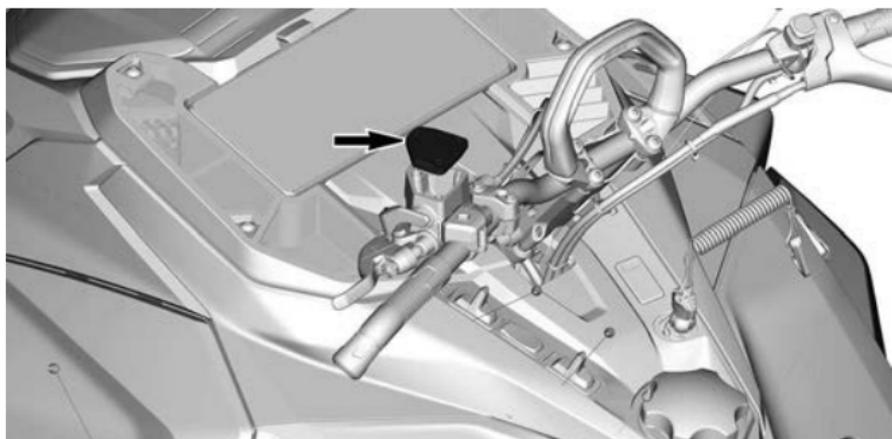
4. Füllen Sie Bremsflüssigkeit nach Bedarf auf. Nicht überfüllen. Verwenden Sie nur empfohlene Bremsflüssigkeit. Siehe *Empfohlene Bremsflüssigkeit* in diesem Unterabschnitt.
