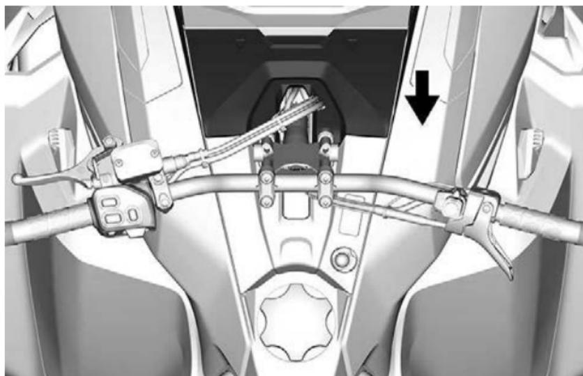
2. Kontrollieren Sie den Kühlflüssigkeitsstand bei Raumtemperatur. Die Flüssigkeit sollte die flache Oberfläche des Sichtglases berühren.
