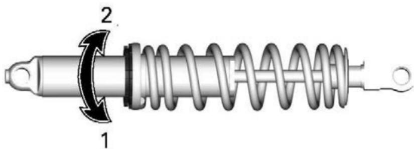
1. Vorspannung erhöhen
