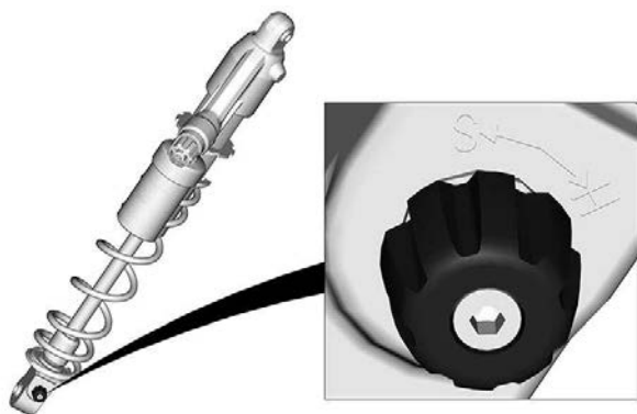
1. Dispositif de réglage de l'amortissement des rebonds
