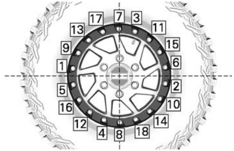
VANLIG – ÅTDRAGNINGSSEKVENS
