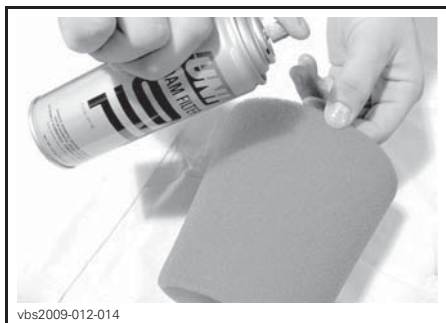
TYPISCH - FILTER MET OLIE SMEREN
