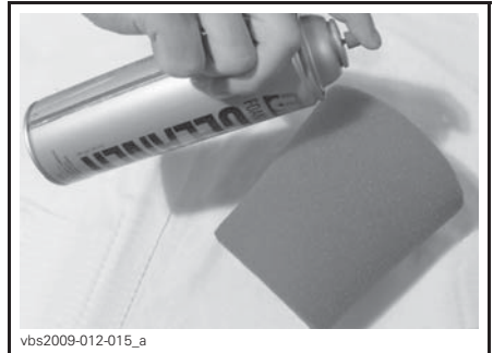
TYPISCH - SPUIT HET OP DE SCHUIMFILTER
