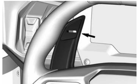
LINKE SCHALTWIPPE HERABSCHALTEN
