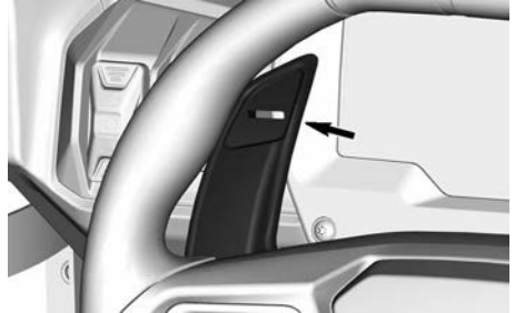
LINKE SCHALTWIPPE HERABSCHALTEN
