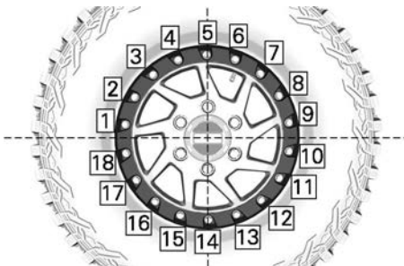
TYPISCH - AANDRAAIVOLGORDE - LAATSTE
