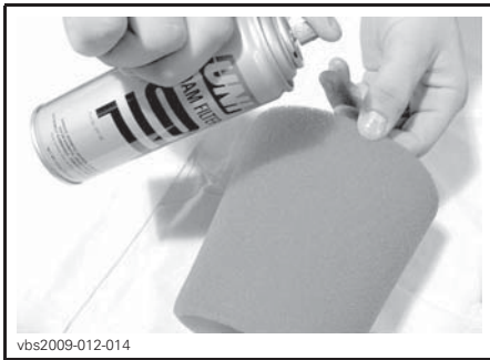
TYPISCH - SCHAUMSTOFFFILTER ÖLEN
