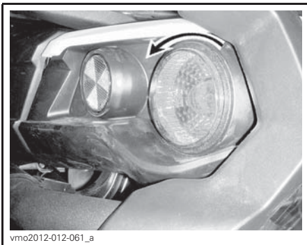
RÜCKLEUCHE ZUM ENTFERNEN GEGEN DEN UHRZEIGERSINN DREHEN
