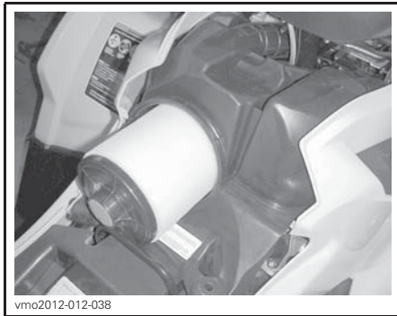
AUSBAU DES LUFTFILTERS
