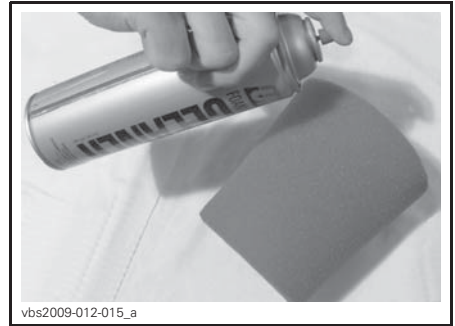
TYPISCH - SCHAUMSTOFFFILTER BESPRÜHEN
