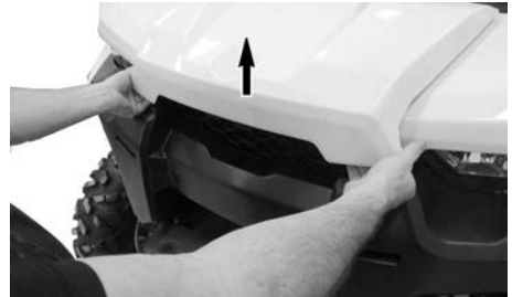
HOCHHEBEN DER WARTUNGSABDECKUNG.
